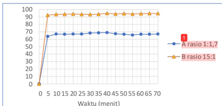
**Gambar 6.** Pengaruh perbandingan mol  $[Mg^{2+}]$ :  $[NH_4^+]$ :  $[PO_4^{3-}]$  pada laju *removal* fosfat pada reaktor tiga kompartemen dengan kecepatan 0,02 meter per detik.
