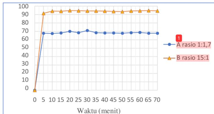
**Gambar 3.** Pengaruh perbandingan mol  $[Mg^{2+}]$ :  $[NH_4^+]$ :  $[PO_4^{3-}]$  pada laju *removal* fosfat pada reaktor dua kompartemen dengan kecepatan 0,02 meter per detik.
