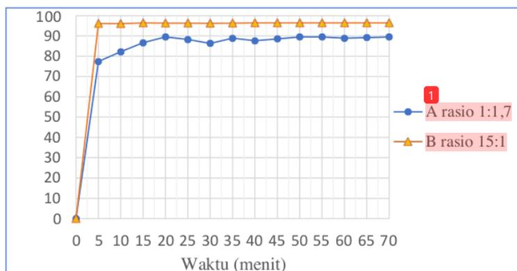
Gambar 2. Pengaruh perbandingan mol  $[Mg^{2+}] : [NH_4^+] : [PO_4^{3-}]$  pada laju *removal* fosfat pada reaktor dua kompartemen dengan kecepatan 0,014 meter per detik.
