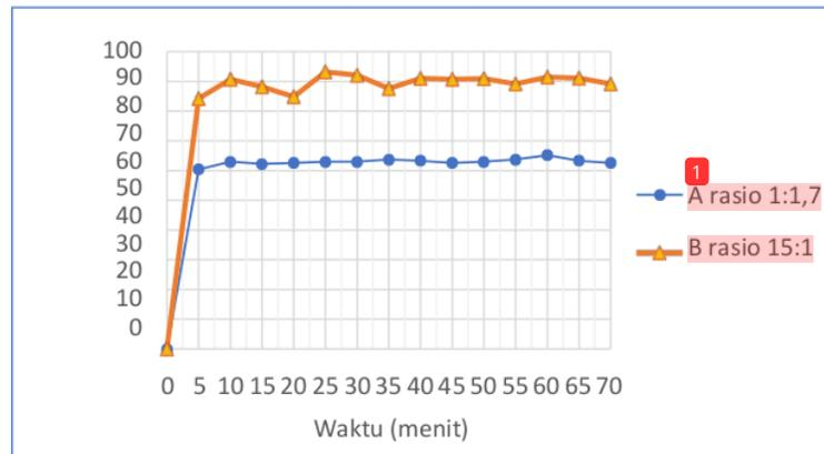
**Gambar 4.** Pengaruh perbandingan mol  $[Mg^{2+}]$ :  $[NH_4^+]$ :  $[PO_4^{3-}]$  pada laju *removal* fosfat pada reaktor dua kompartemen dengan kecepatan 0,0127 meter per detik.
