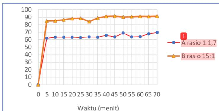
**Gambar 7.** Pengaruh perbandingan mol  $[Mg^{2+}]$ :  $[NH_4^+]$ :  $[PO_4^{3-}]$  pada laju *removal* fosfat pada reaktor tiga kompartemen dengan kecepatan 0,027 meter per detik.
