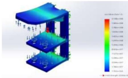
Gambar 4. Hasil pengujian tegangan.
