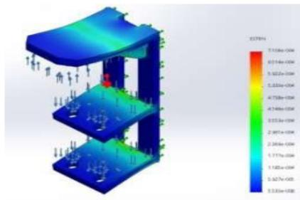
Gambar 6. Hasil pengujian regangan.
