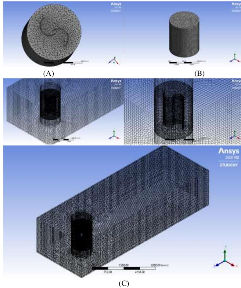
Gambar 2. Konfigurasi mesh pada rotor, domain putar, dan domain stasioner (A, B, and C).
