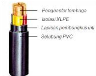
**Gambar 2.4.** Konstruksi kabel N2XY
