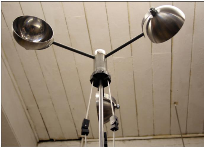
Gambar 2.10 Anemometer Mangkok
