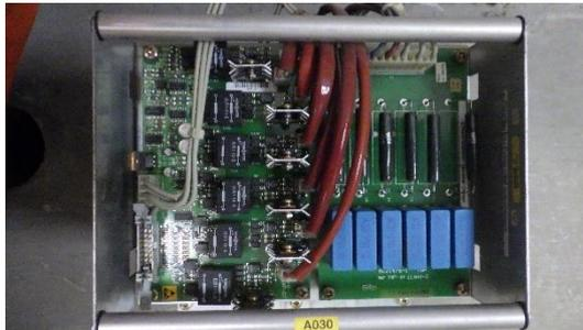
Gambar 2.5 rangkaian rectifier
