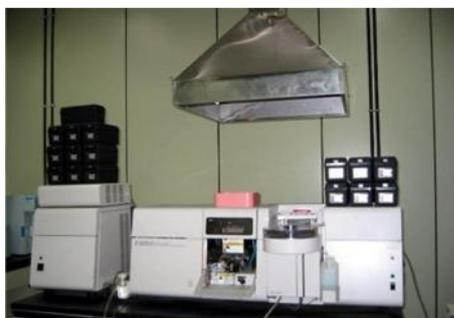
**Gambar 2.5.1 Spektrofotometri Serapan Atom SSA/AAS (Retno, 2012).**
