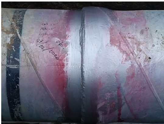
Gambar 2. Hasil pengelasan socket welded yang sudah di penetrant (sumber data internal OP BBWS Brantas)
