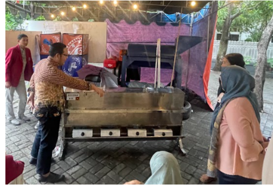
Gambar 6. Proses Pengukusan Kain Ecoprint Pada Mesin Pengukus
