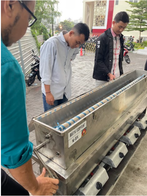
Gambar 5. Pengujian Mesin Pengukus Kain Ecoprint
